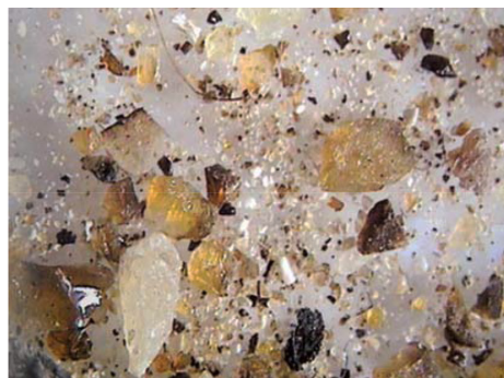
Рис. 7. Роговые фрагменты КРС после термической обработки (стереомикроскоп, ×6,4)
